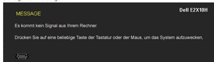
Falls entweder der VGA- oder der DVI-D-Eingang ausgewählt wurden und weder das VGA- noch das DVI-D-Kabel angeschlossen sind, erscheint das nachstehende schwebende Dialogfenster.
